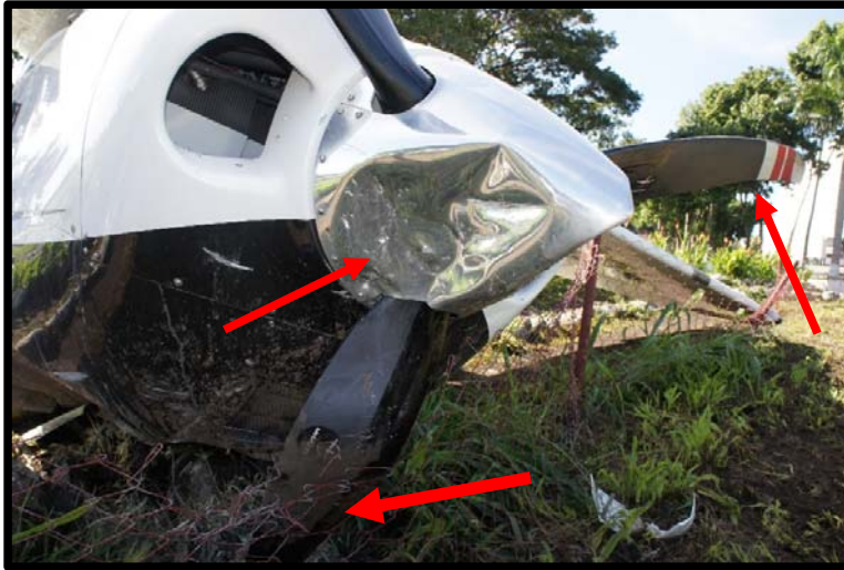
Fotografía No. 5 Daños en el yugo de las aspas de hélice.
