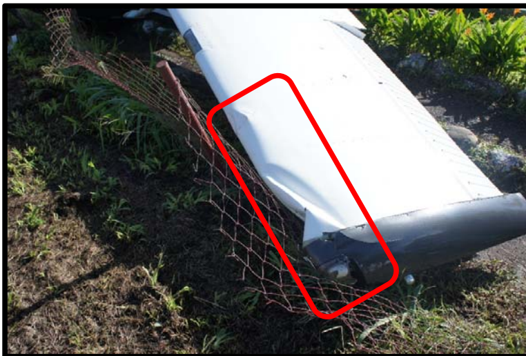
Fotografía No. 10 Vista de la punta de ala izquierda golpeada.
