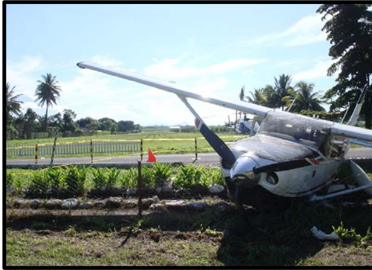
Fotografía No. 7 Daños en el tren principal y de nariz.
