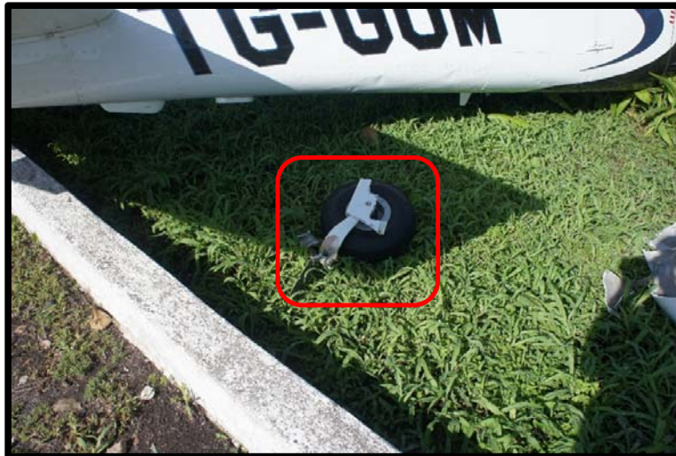
Fotografía No. 3 Rueda delantera desprendida.
